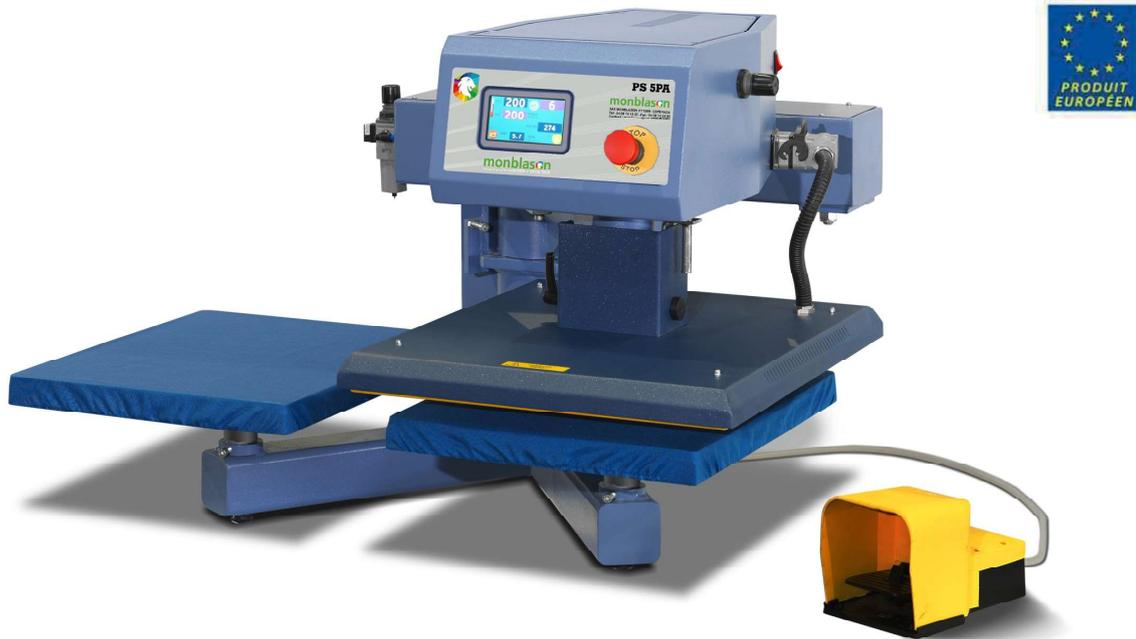
Presse à transfert pneumatique pourvue de deux tables de travail permettant un travail en temps masqué. La descente et transition latérale se font en actionnant la pédale, offrant ainsi un confort optimal. La remontée du plateau se fait automatiquement en fin de cycle.
